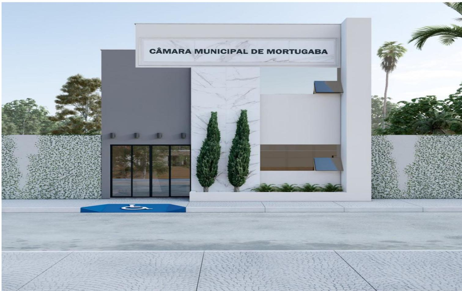
No centro da fachada, receberá um revestimento de porcelanato calacato com 2 metros de largura e 7 metros em média de altura, o nome será em ACM. Será executada uma marquise de modo de um shaft e o jardim em alvenaria. Na marquise será instalada 3 dicróicas da cor branca.
